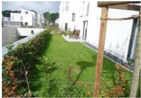
Tiefgaragendach (Grünfläche, Porenpflaster Faktor 0,3, Pflaster Faktor 0,6)
